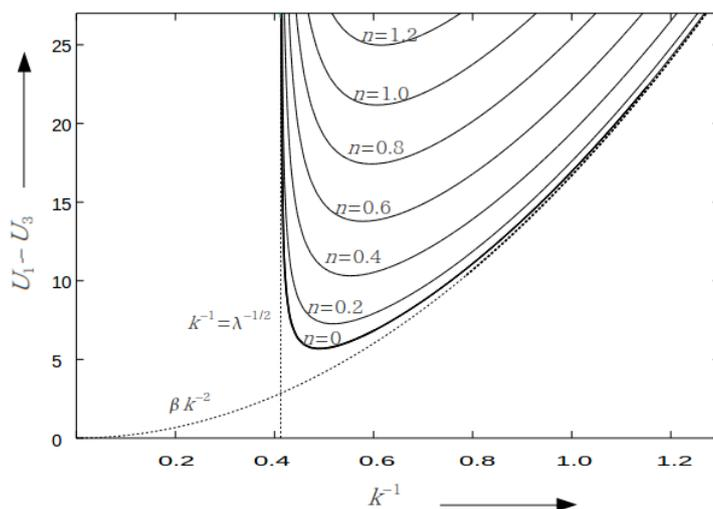
図 4.9.9:  $\lambda = 5.88 \times 10^{-12} \text{ m}^{-2}$ ,  $\beta = 1.67 \times 10^{-11} \text{ m}^{-2}\text{s}^{-1}$  に固定したときの 2 層モデルにおける成長率  $n = k|c_i|$  のグラフ。  $n$  は  $U_1 - U_3$  と  $k^{-1}$  の関数となっている。なお、  $k^{-1}$ ,  $U_1 - U_3$ ,  $n$  の単位はそれぞれ  $10^6 \text{ m}$ ,  $\text{ms}^{-1}$ ,  $10^{-5} \text{ s}^{-1}$  である。
