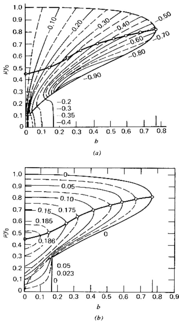
図 4.4.4: Kuo(1973) による  $U = U_0 \tanh(y/y_0)$  に対する固有値. (a)  $b$  と  $ky_0$  の関数として見たときの  $c_r/|U_0|$  のグラフ; (b)  $b$  と  $ky_0$  の関数として見たときの成長率  $\delta$  のグラフ. (H.L.Kuo, *Dynamics of Quasi-geostrophic Flows*. Academic Press, 1973.)
