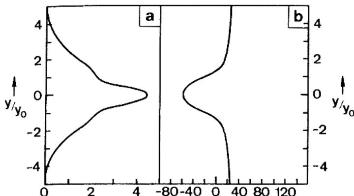
図 4.4.5: Bickley ジェットに対する最も不安定な解の構造. (a) 振幅  $P$  のグラフ; (b) 位相  $\theta$  のグラフ (横軸の単位は度). (Haltiner, G.J., Williams, R.T., 1979: NUMERICAL PREDICTION AND DYNAMIC METEOROLOGY SECOND EDITION. John Wiley & Sons, 477pp)
