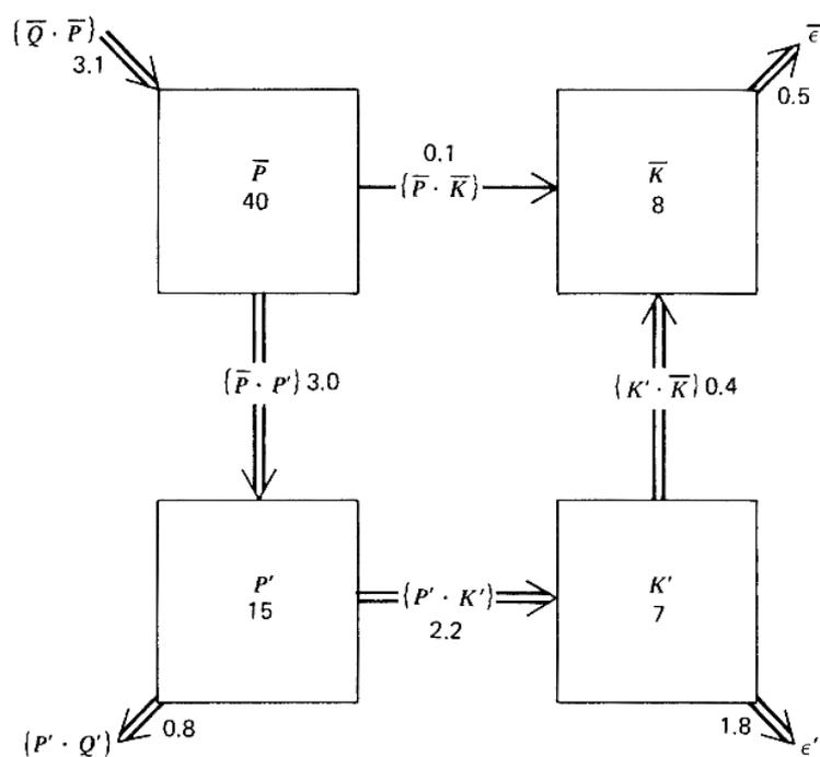
図 4.10.11: Oort(1964) のデータによる大気のエネルギサイクル. ボックスの内の数字は, 観測される北半球の各エネルギー値の年平均を示している. 単位は  $10^5 \text{ J m}^{-2}$  である. また, エネルギ変換を表す矢印の下の数字の単位は  $\text{Wm}^{-2}$  である. (Oort, A.H., 1964: On Estimates of the Atmospheric Energy Cycle., *American Meteorological Society* より引用)
