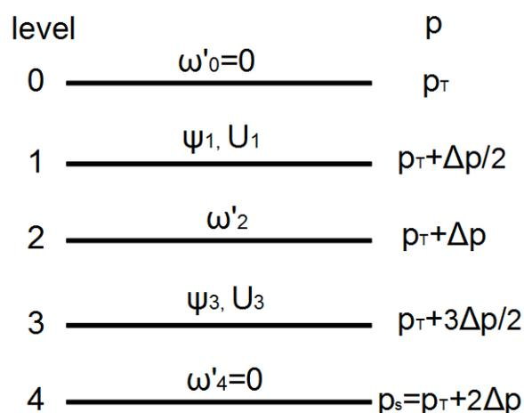
図 4.9.8: 2 層モデルの鉛直構造
