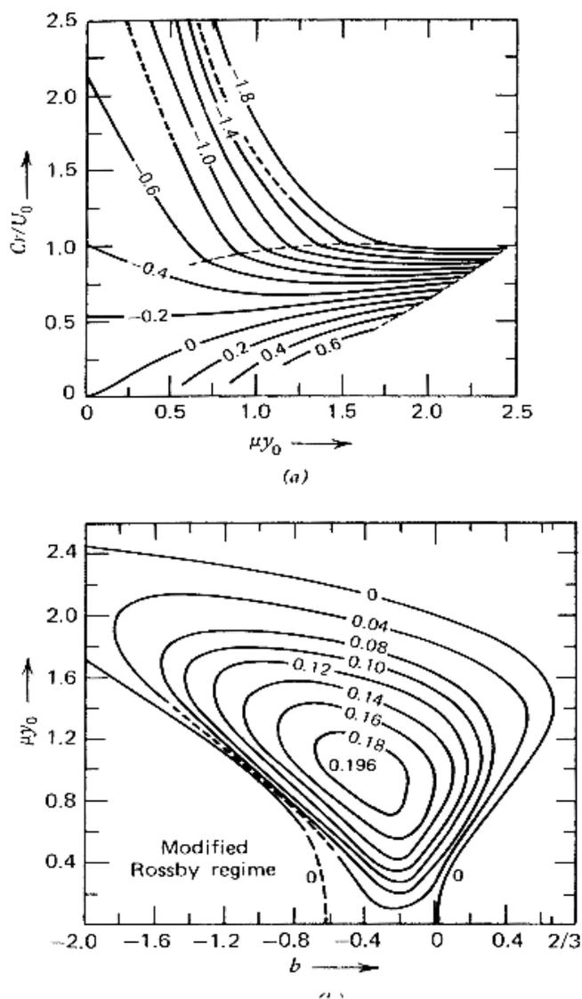
図 4.4.3: Kuo(1973) による  $U = U_0 \text{sech}^2(y/y_0)$  に対する固有値. (a)  $ky_0$  と  $c_r/U_0$  の関数として見たときの  $b$  のグラフ; (b)  $b$  と無次元波数  $ky_0$  の関数として見たときの成長率  $\delta$ . (H.L.Kuo, *Dynamics of Quasi-geostrophic Flows*. Academic Press, 1973.)
